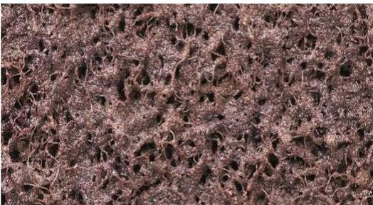
Das Scotch-Brite™ Vliesband DF-BL eignet sich ideal zum Entgraten, Mattieren und Finishen von sämtlichen Edelstahl- und Stahlbauteilen sowie Entfernen von Anlauffarben. Auch das Auftragen eines definierten Finishs auf großen Flächen sowie Reduzierung der Rautiefe ist mit diesem Vliesband garantiert. Darüber hinaus kommt dieses Band auch auf Anwendungen auf Holz und Kunststoffen zum Einsatz.
